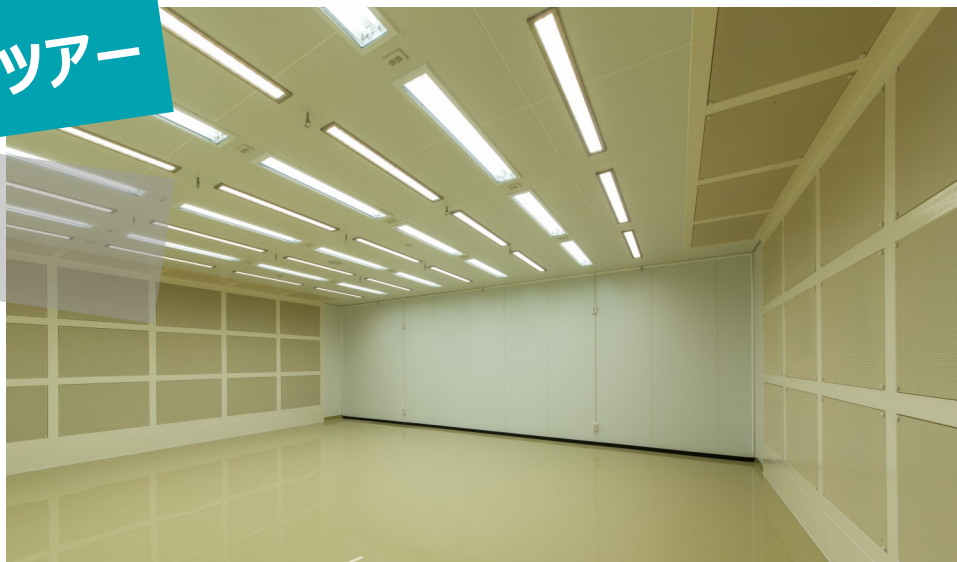
風向風速、温湿度、光可変式の昆虫実験室
